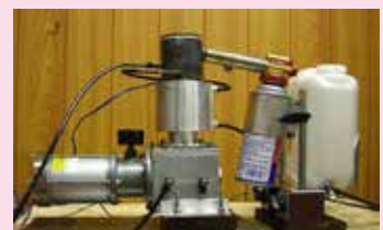
小型熱・電力併給システム（CHP）
