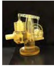
3Dプリンターで製作したスターリングエンジンのアクリル樹脂模型
