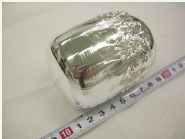
精製された握りこぶし大の 超高純度大型単結晶アルミニウム
