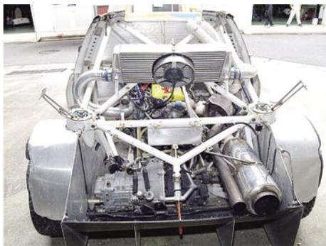
パイプフレーム、エンジン・駆動系と給排気系の外観
