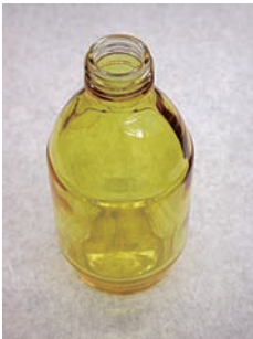
「リサイクル性に富んだ染色法による瓶着色コーティングプロセス」で試作したガラス瓶
