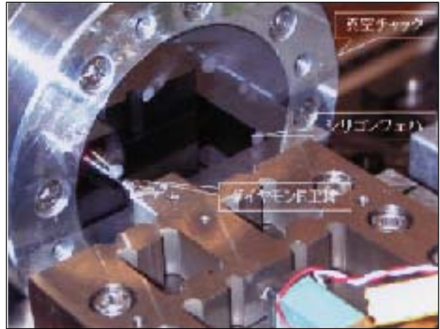
図4 シリコンウェハの超精密加工試験
