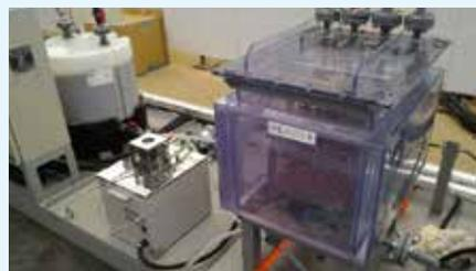
福島の汚染水を浄化処理する光合成細菌ビーズ（水槽中の赤い球）を用いた浄化槽
