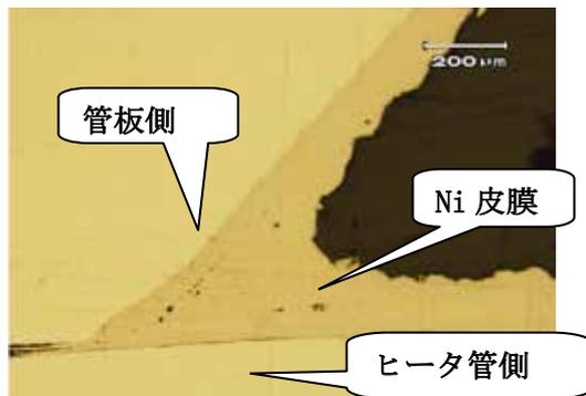
図1 加熱器接合部のNi皮膜
