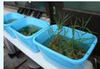
研究室ベランダに設置されている水生植物による水質浄化実験
