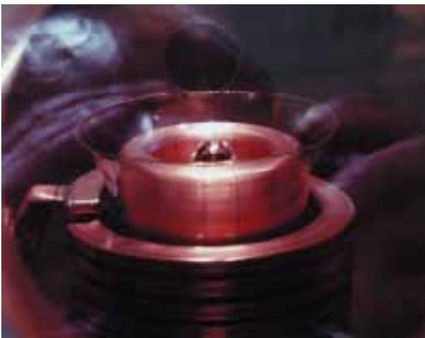
写真4 横フランジ窓より、中心の黒光りしているのがアルミニウム試料。溶解中は酸化皮膜も無く、鏡面ようになっている。周囲が暗いので黒光りしているように見える。
