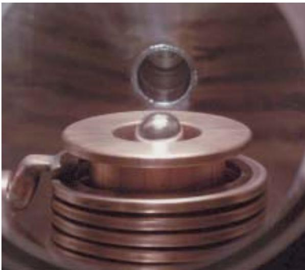
超高真空溶解中のアルミニウム（中央部少し頭を出しているのが液体アルミニウム）
