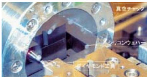
超精密加工試験機とダイヤモンド工具を用いてシリコンウェハーを切削中のようす（シリコンウェハーが鏡面であるために透明のように見える）。
