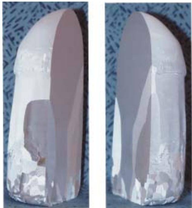
超高真空溶解したアルミニウム試料を切断したところ（直径60mm 長さ100mm）。色違って見える部分はそれぞれ単結晶でかなり大きい。
